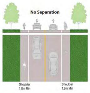
FIGURE C-27 // OFF-ROAD PATHWAY VS. NO SEPARATION
